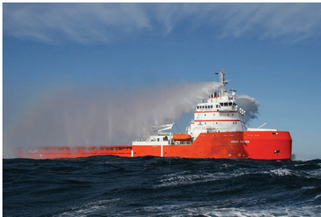
МФЛС «Юрий Топчев» со специальной системой тушения пожара на внешних объектах в действии
