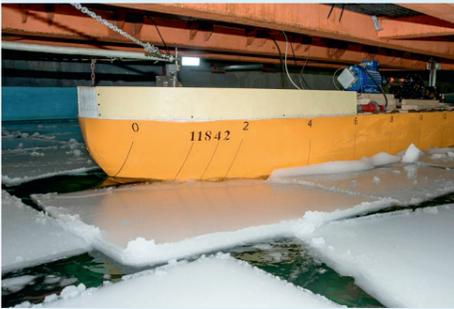
**В** третьей декаде июля в испытательных бассейнах ФГУП «Крыловский государственный научный центр» проводились гидродинамические, ледовые и циркуляционные испытания модели многоцелевого судна обеспечения (МСО), в которых принимали участие, в том числе, и специалисты филиала ООО «Газпром флот» в г. Санкт-Петербурге. Проект МСО разрабатывается ФГУП «Крыловский государственный научный центр» в интересах российских предприятий, работающих на шельфе.
